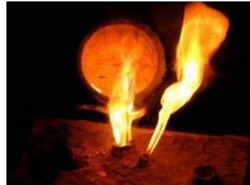
11. On attend un peu et on les plonge complètement dans un chaudron rempli d'eau jusqu'à refroidissement. On casse la coquille de céramique avec un marteau.
