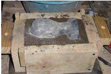
Moule sur un buste de cire. En faisant tout à la suite, sans attendre, caoutchouc siliconé et recouvrant le tout de plâtre.
