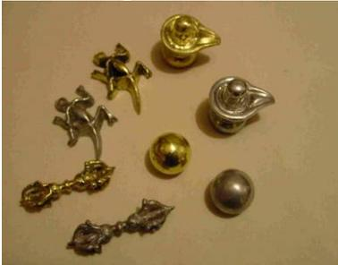
On a utilisé du bronze de différentes qualités, sans connaître exactement son alliage. Température de fusion de 1.200 à 1280°C. Les premières fusions ont été réalisées dans un four avec isolation de laine céramique et un feu à gaz butane. On a utilisé un creuset de carbure de silicium avec une capacité d'environ 15 kg. Ensuite, on a continué à le fondre dans le four de charbon de coke et dans la forge.
