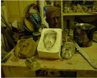
La matrice -ou pièce depuis laquelle a été réalisé le moule- devra être imperméabilisée et enduite d'un démoulant (vaseline, graisse, huile) qui doit être étendu avec soin. Ensuite on fait un contenant et on prépare le plâtre (2 portions de plâtre pour 1 portion d'eau). Si on utilise du plâtre pour couler de la cire, on l'imperméabilise avec de l'huile et on le mouille avec de l'eau avant de couler la cire.
