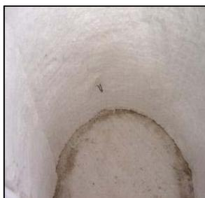
À mi-hauteur du tonneau, on fait une perforation dans la paroi métallique et dans la laine céramique pour pouvoir y glisser le pyromètre.
