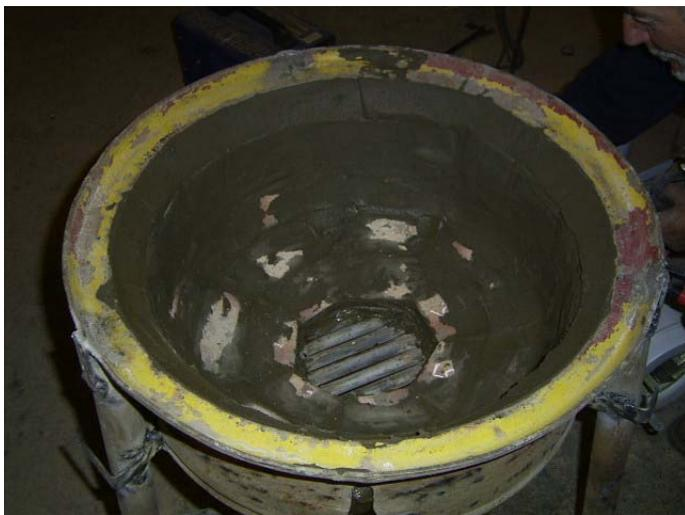
Morceaux longs de brique réfractaire collés avec du ciment spécial à l'intérieur de la forge. Remarquez les barres d'acier au centre, qui permettent à l'air d'entrer et empêchent les cendres d'obstruer le cendrier.
