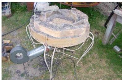
Forge fonctionnant avec aérateur et coke, en mesure de fondre du fer en creuset ouvert.
