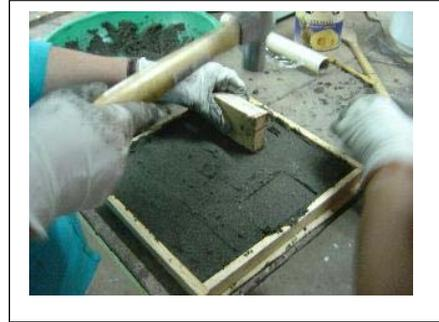
Ensuite, on place un carton par-dessus afin de pouvoir retourner l'ensemble et sortir l'objet original. (Comme il est recouvert d'un film, celui-ci se décolle facilement).
