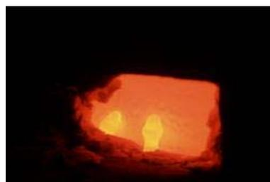
On éteint le gaz, on ouvre la porte et on laisse refroidir jusqu'à ce que la céramique soit tiède.
