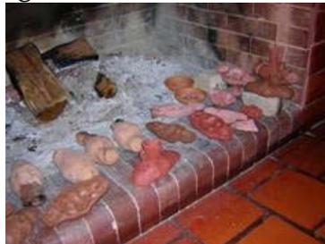
5. Les fissures des moules sont réparées avec un mélange d'argile et de vinaigre.
