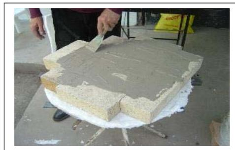
Au moment de l'utiliser, on dépose le creuset sur le sol du four (avec le métal à fondre) lui-même appuyé sur une brique réfractaire et sur du papier journal (la cendre du papier brûlé évitera que le creuset colle à la brique).
