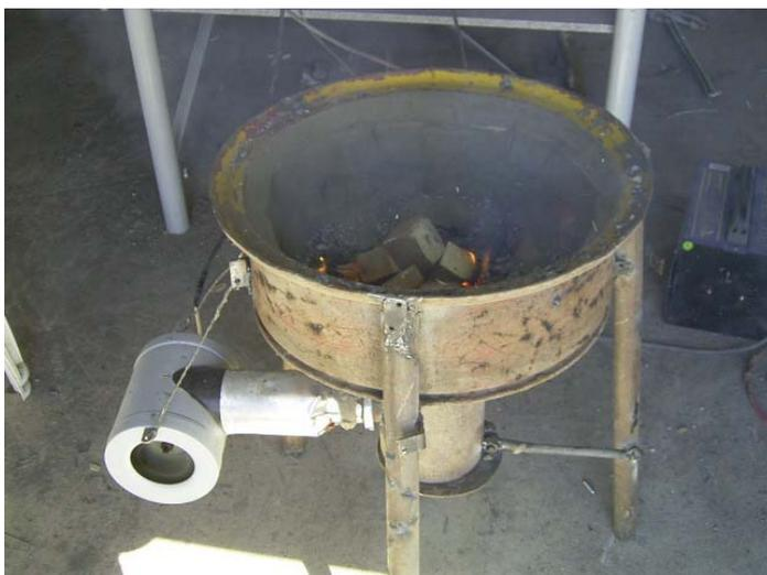
Notre forge terminée. À gauche, le ventilateur (récupéré d'une hotte de cuisine). On observe le mécanisme de contrôle du flux d'air qui s'obtient en ouvrant ou fermant la trappe inférieure du cendrier. On place du charbon coke à l'intérieur avec quelques brindilles qui s'enflamment. L'air du ventilateur avive le feu... qui peut ainsi atteindre plus de 1200°
