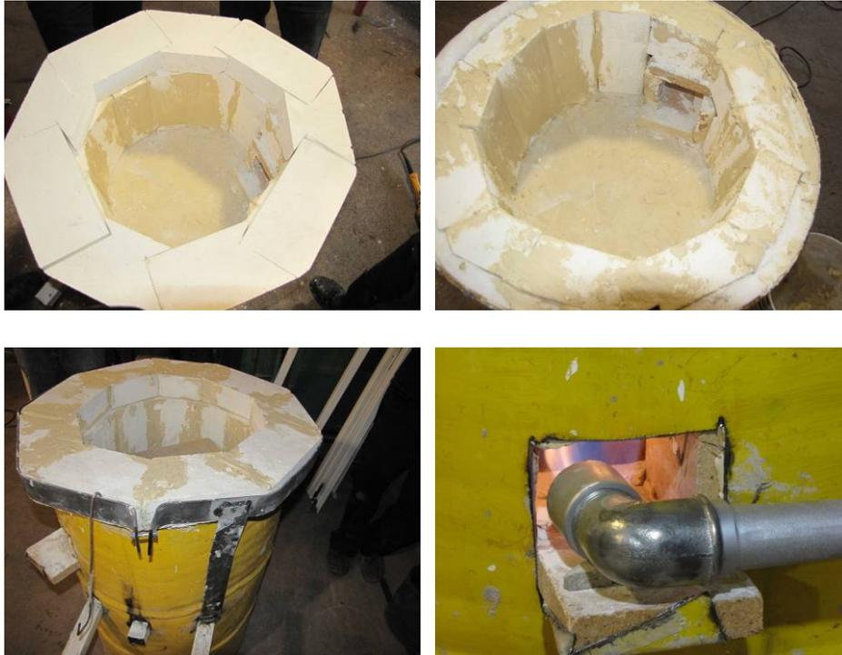
**La bouche d'entrée du feu** se fait entièrement en briques, orientée en diagonale vers la gauche, pour que le feu tourne à l'intérieur du four.
