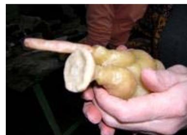
3 bis. Doubles coques : On recouvre d'abord la cire avec un démoulant (vaseline solide), on répète le pas antérieur en recouvrant avec l'argile, puis on découpe l'argile en deux moitiés (momie) et on sépare l'argile de la cire ; dans l'une des coques, on a fait deux trous (l'un de 1 cm de diamètre et l'autre plus petit de 0,5 cm) et on y fixe l'entonnoir pour verser le métal dans le plus grand trou et dans l'autre on fait un tirage pour l'air, les deux en argile.
