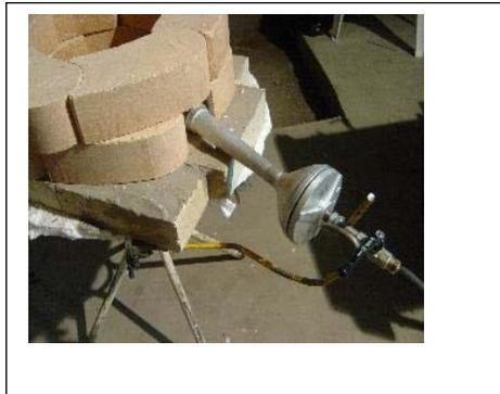
Sur la laine réfractaire, on place un plancher de briques réfractaires (1200°) jointes avec du ciment réfractaire. Pour notre four, nous avons utilisé 10 briques.
