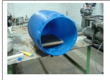
Puis on ferme le bidon en l'ajustant bien avec le collier. On visse le tuyau de gaz à la valve de gonflage et l'on envoie le gaz jusqu'à ce que le couvercle gonfle un peu. (Ouvrir et fermer le gaz).
