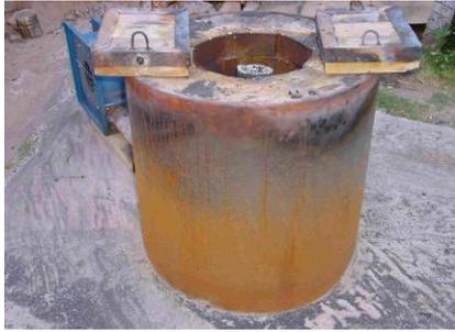
La fabrication d'un four pour fondre le bronze s'est faite sur la base de briques réfractaires (avec une entrée latérale pour le brûleur à gaz). L'extérieur a été couvert de laine céramique et d'acier.
