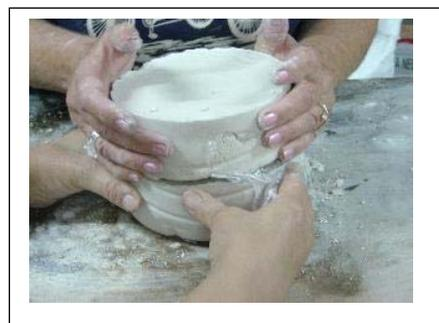
Après que le deuxième plâtre ait pris et se soit durci, on sort avec précautions les deux coques de plâtre (qui sont séparées par le film) les séparant de l'original. Dans le premier plâtre, il y a les trous de la clef (dans le deuxième plâtre apparaissent les positifs de la clé).
