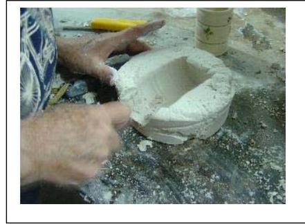
Une fois que les deux plâtres sont bien secs, on les assemble avec des bandes adhésives (gros scotch ou élastiques), puis on y verse la barbotine (argile liquide et quelque chose en plus, voir fichier moules céramiques)
