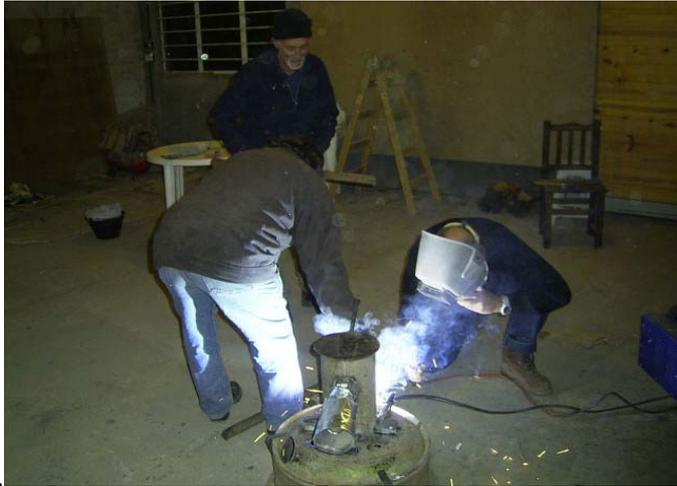
Soudure du cendrier, qui est le tube inférieur par où entre l'air, et permet que les cendres n'obstruent pas les orifices d'entrée.
