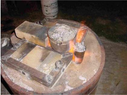
Peltre et aluminium atteignant la fusion dans le four. On a utilisé des barres avec un alliage de fonderie. Température approximative de fusion à 800°C.
