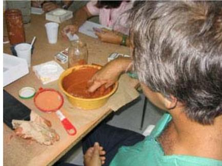
Les deux parties de la coque doivent être très lisses pour qu'elles s'emboîtent bien. Le produit utilisé comme démoulant a joué un rôle fondamental dans les essais réalisés. On peut utiliser de façon sûre la vaseline ou l'huile d'olive, mais en prêtant attention à ce qu'il ne reste pas de résidus qui abîment la copie finale sous forme de tâches ou de gouttes. Dans la recherche d'un démoulant définitif, le lubrifiant du type 3 en 1 a donné de très bons résultats.
