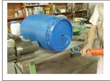
On attend 10 minutes puis on ouvre le bidon. En fonction de la dureté du moule (on peut tester avec les ongles) on répètera ou non l'opération.
