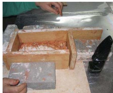
Si l'original a des cavités, il faut les remplir pour que nous n'ayons pas de difficultés au moment d'extraire le positif. Les bords et les côtés ne devraient pas non plus créer de concavités dans le moule, même si tous ces détails peuvent être taillés et profilés avec un stylet une fois que la pièce est sèche et qu'on l'a extraite du négatif.
