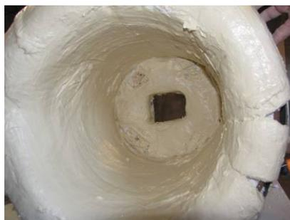
Une fois le kaolin sec, on découpe l'ouverture supérieure en faisant des coupes dans la laine.
