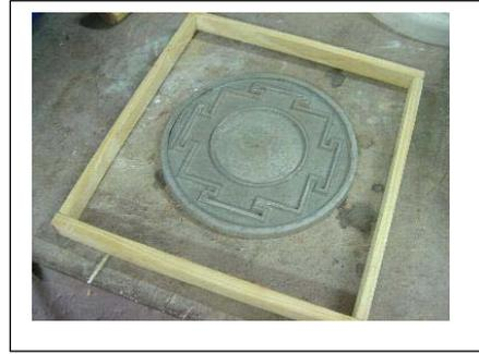
On recouvre l'objet d'un film transparent, puis on le recouvre de sable préparé comme indiqué ci-dessus jusqu'à ras bord du cadre et l'on tasse bien.
