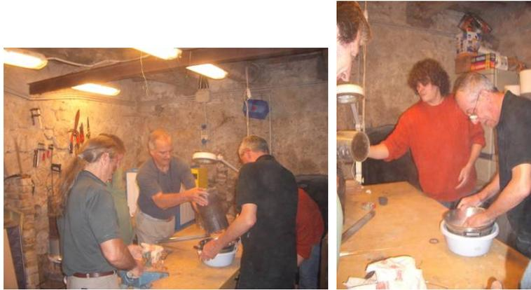
On mélange parfaitement les deux composants et ensuite ... encore un peu plus ! Terminer de malaxer, puis frapper les blocs obtenus pour chasser l'air.
