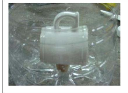
On verse le plâtre jusqu'à la moitié de la tasse. Une fois qu'il a pris, mais alors qu'il est encore frais, on y fait des trous en deux endroits (qui constitueront le négatif de la clef, pour que s'ajuste parfaitement l'autre plâtre). Les clefs des deux coques doivent être grandes et doivent s'ajuster parfaitement.
