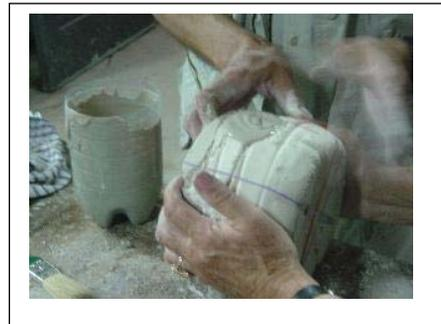
On la laisse prendre une ou deux heures environ (ceci dépend de la température ambiante et du degré de séchage du plâtre) puis on verse le trop plein. Une pellicule de 1/2 cm d'épaisseur reste adhérente au plâtre.
