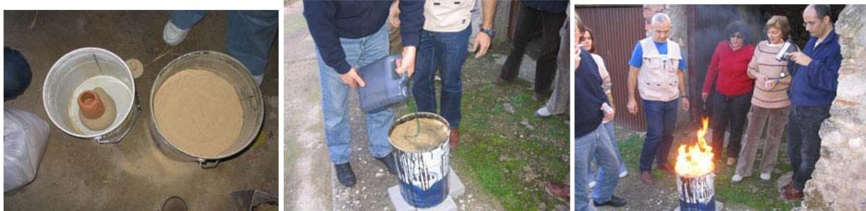
Après la dernière couche, on met 4 autres centimètres de sciure et l'on pulvérise la surface avec un carburant, comme du kérosène. On met le feu et on bouche le bidon de manière à ce que, comme il y a une moindre quantité d'oxygène, se produise une combustion lente. De temps en temps, il faut vérifier que cela fume pour s'assurer que la braise ne s'est pas éteinte. On peut aussi surélever le bidon sur des pierres pour qu'il y ait un peu plus de ventilation et que le feu consume toute la sciure.
